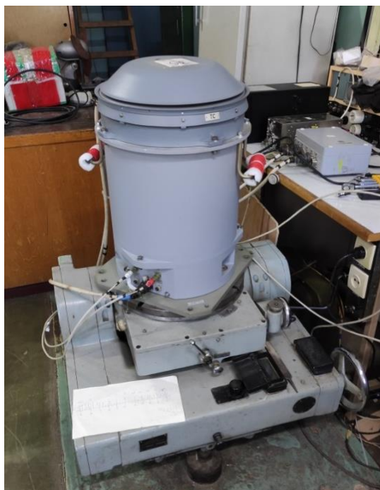
Рисунок 1.4 — Мобильный гравиметр «Чекан-АМ» на наклонно-поворотной плите. Фотография автора работы
