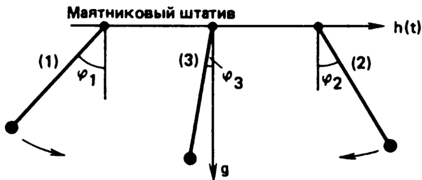
Рисунок 1.1 — Принцип работы трехмаятникового прибора Венинг-Мейнеса [Торге, 1999]
